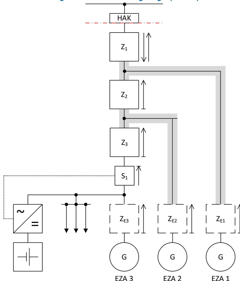
Abbildung 20: ABK AE1 – Anschlussbeispiel mit mehreren Erzeugungsanlagen und Speicher
