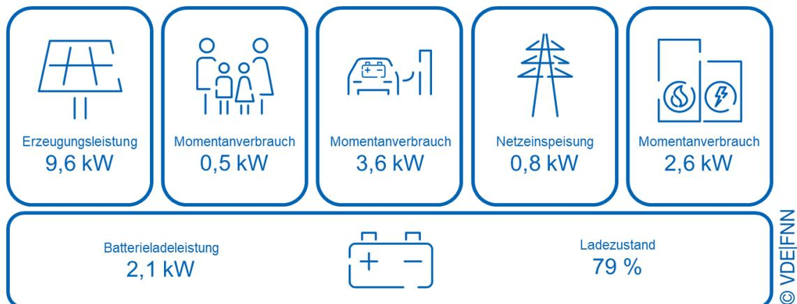
Abbildung 7: Visualisierung Leistungsflüsse
