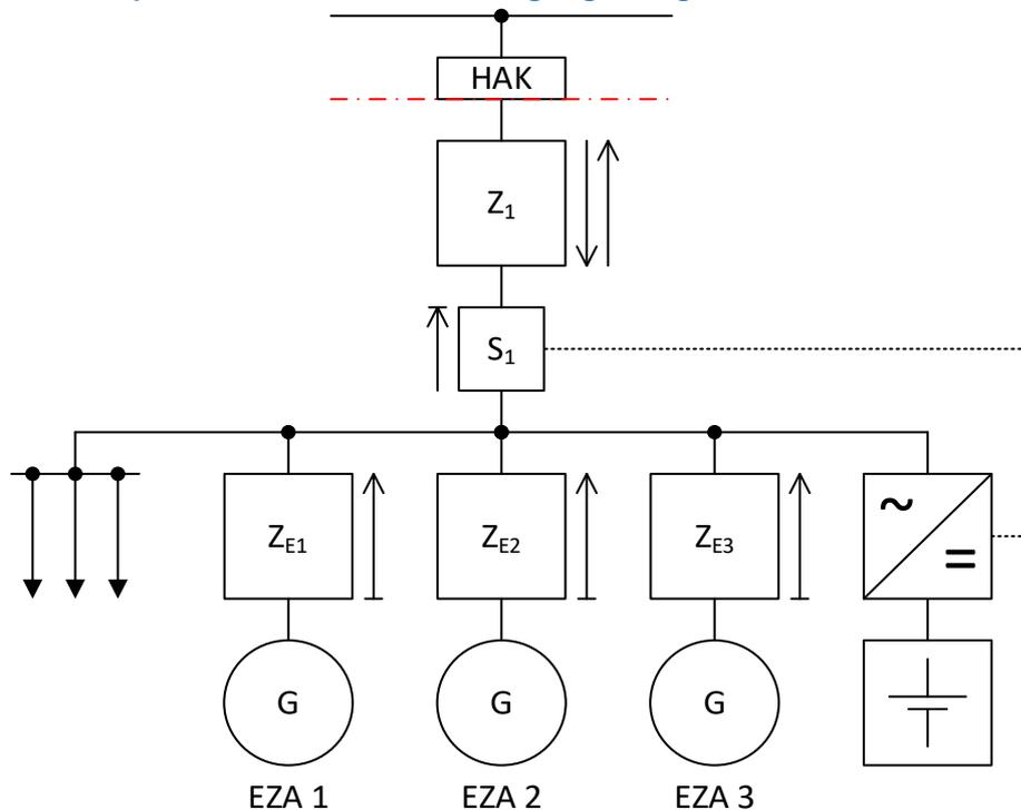
Abbildung 26: ABK W1 – Komplexes Anschlussbeispiel mit mehreren Erzeugungsanlagen und Speicher bei höheren Leistungsgrenzen
