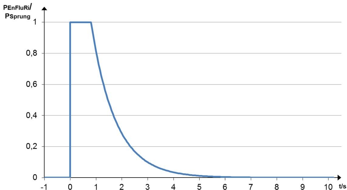
Abbildung 1: Wirkleistungs-Grenzkurve für die Funktion des EnFluRi-Sensors
