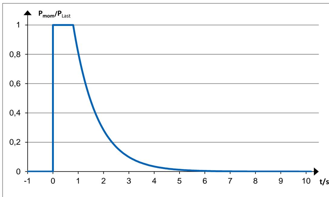
Abbildung 4: Wirkleistungs-Grenzkurve für die Rückspeisung ins Netz
