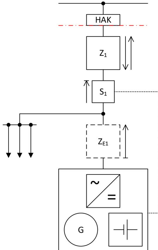
Abbildung 14: ABK N1 – Erzeugungsanlage mit Speicher bei Nulleinspeisung
