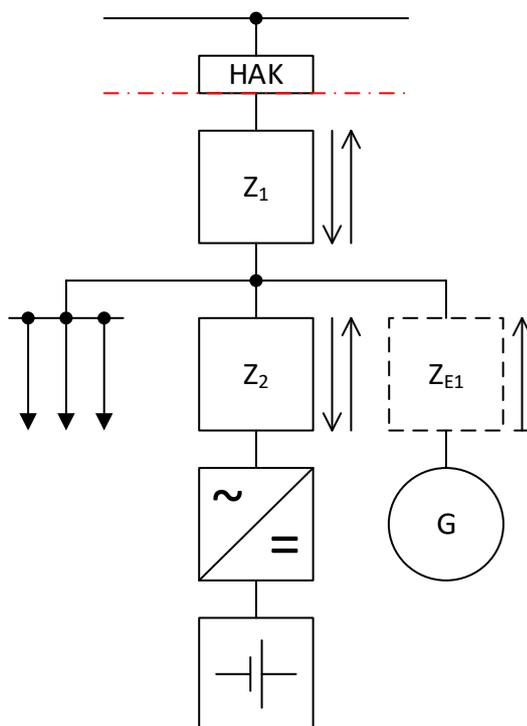
Abbildung 28: ABK W3 – Speicher mit Mehrfachanwendung durch gewillkürte Vorrangregelung
