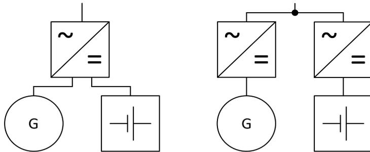
Abbildung 6: DC-Kopplung (links) und AC-Kopplung (rechts) bei Speichern mit PV-Anlagen
