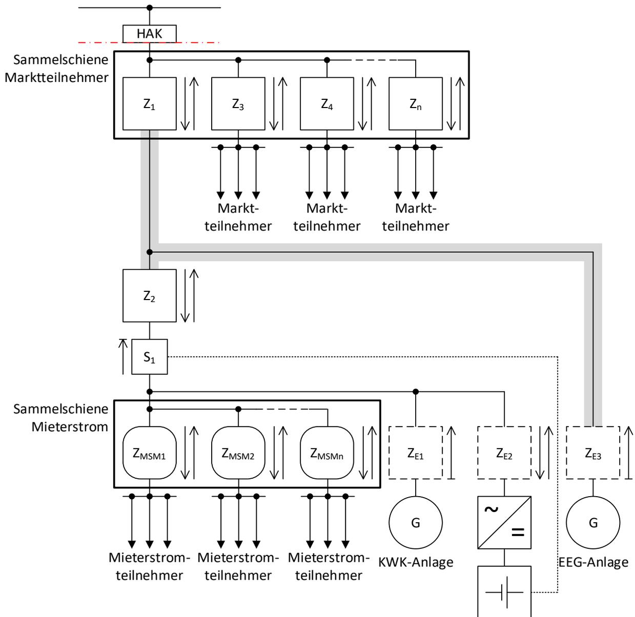
Abbildung 19: ABK M5 – Mieterstrommodell als doppeltes Sammelschienenmodell mit zwei verschiedenen Erzeugungsanlagen und Speicher
