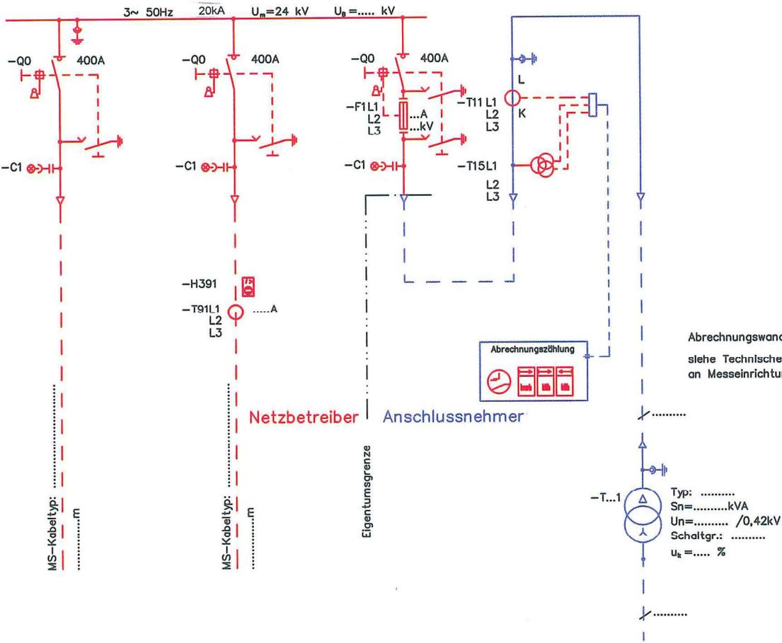
Der Netzbetreiber errichtet und betreibt die Mittelspannungskabelfelder und das Trafofeld.
