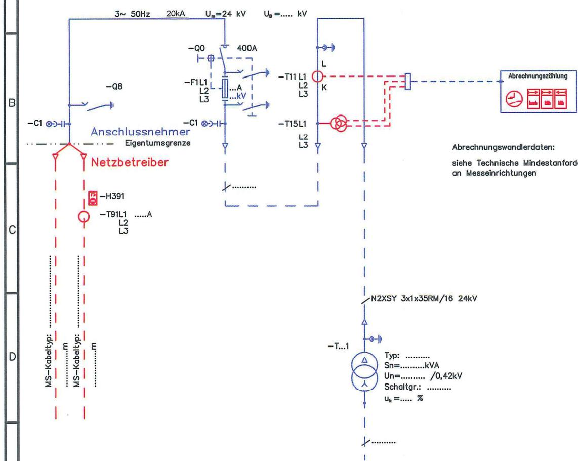
Der Anschlussnehmer errichtet und betreibt die komplette Mittelspannungsschaltanlage.
