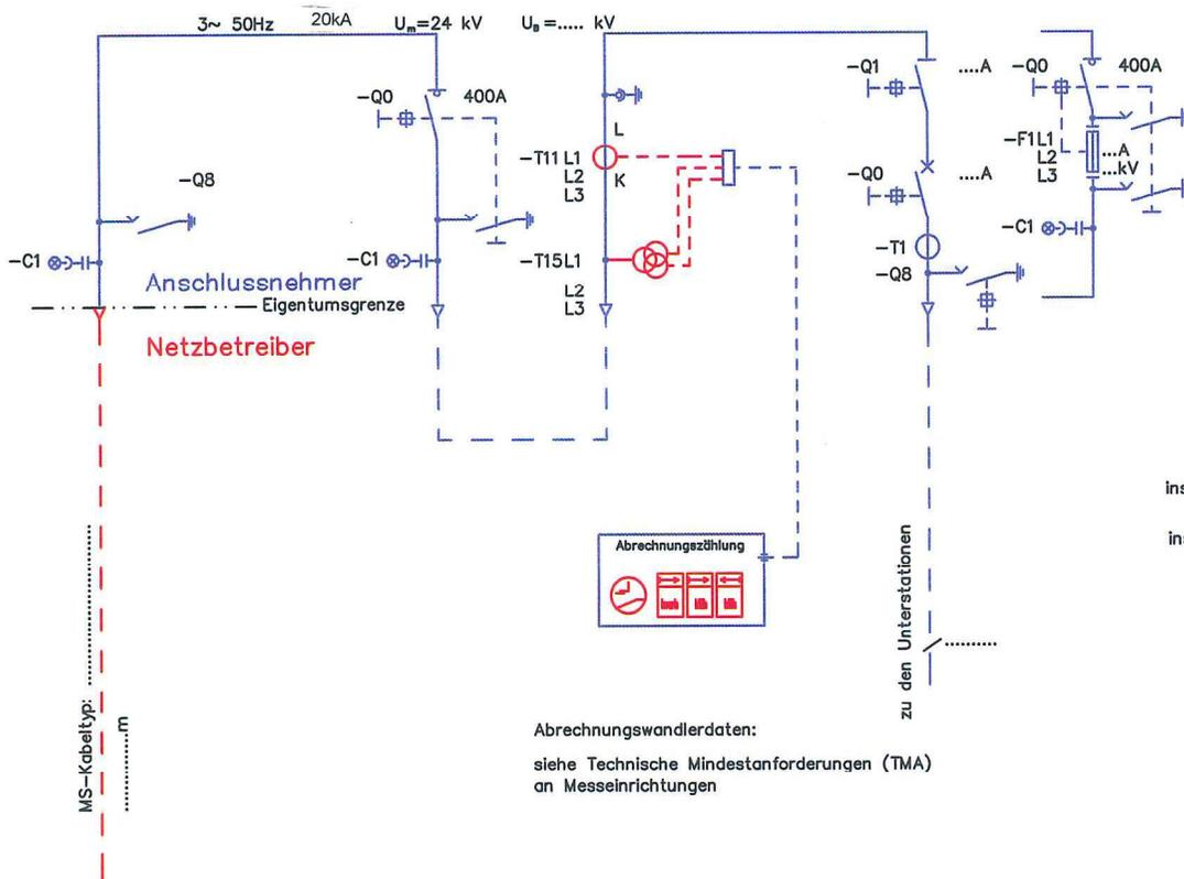
Der Anschlussnehmer errichtet und betreibt die komplette Mittelspannungsschaltanlage.
