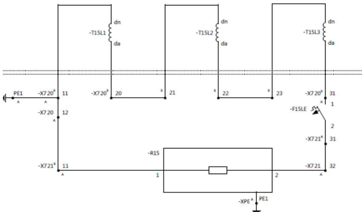
Zur Absicherung ist mindestens ein einpoliger Leitungsschutzschalter vorzusehen. Die Erdschlusshilfswick- lung muss mit einem Widerstand 25 Ω, 6 A, 500 VA bedämpft werden, um Kippschwingungen zu verhin- dern. Die Sekundärverdrahtung der Spannungswandler bis zum Spannungswandlerautomat muss mit ei- ner NSGAFÖU-Leitung (Mindestquerschnitt 2,5 mm<sup>2</sup>) realisiert werden.
