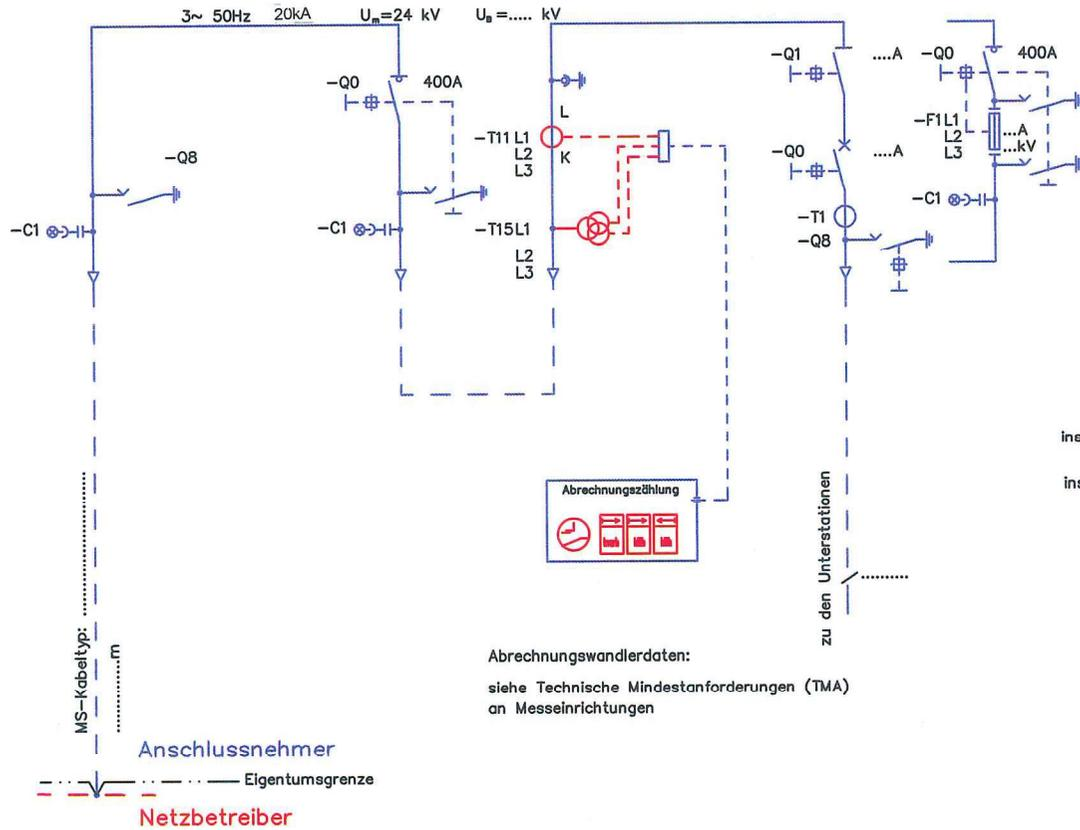
Der Anschlussnehmer errichtet und betreibt die komplette Mittelspannungsschaltanlage und das Mittelspannungsanschlusskabel.
