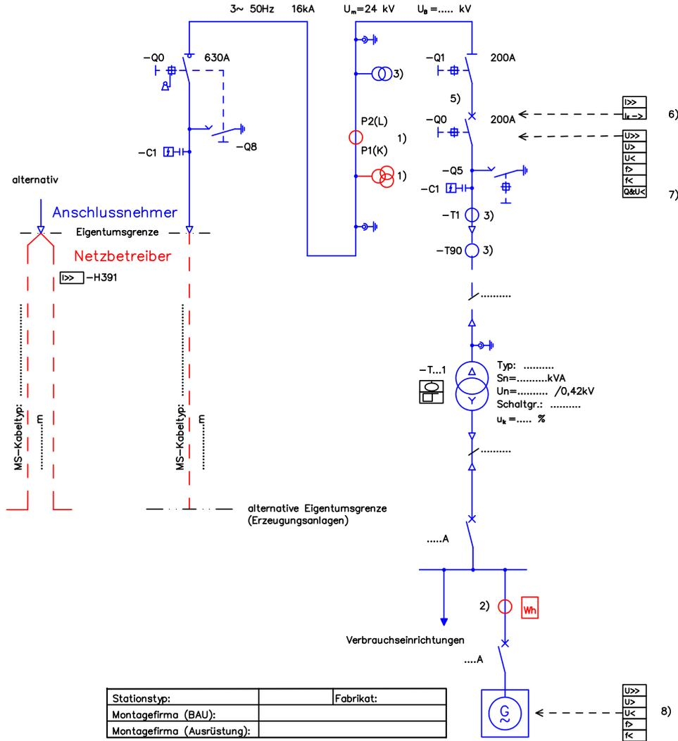
Messwerterfassung für Datenfernübertragung und übergeordneten Entkopplungsschutz erfolgt mittelspannungsseitig
