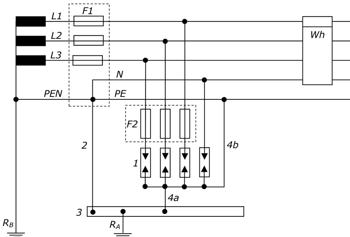
Die vierte ÜSE Typ 1 zwischen N und PE kann dann entfallen, wenn deren Einbauort in unmittelbarer Nähe der Aufteilungsstelle des PEN-Leiters in N und PE liegt.
